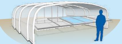
La façade basculante s'ouvre sur le même principe qu'une porte de garage de bas en haut. Abridays bascule à mi hauteur de l'abri, coulisse sur un rail et vient ensuite se plaquer sur la façade opposée. Cette solution permet d'ouvrir l'abri sur toute sa largeur sans entrave au sol et le bassin restant couvert. Cette façade équipe uniquement le modèle 850T.
